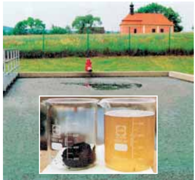
Fangos digeridos se convierten en filtrado limpio y fango deshidratado con grados de sequedad hasta 25-30% MS.
