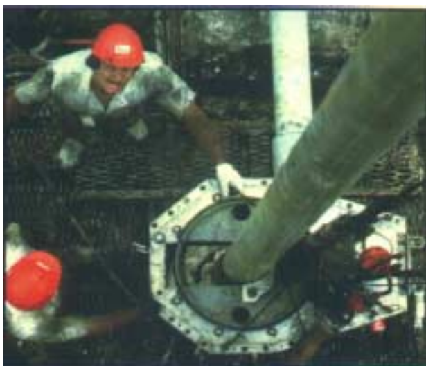
BISHOP, TEXAS, 1989 TUBING DE INYECCIÓN STAR PARA POZO DE EVACUACIÓN DE DESPERDICIOS QUIMICOS DE 7" 2,000 lb7plg 2 1,250 m
